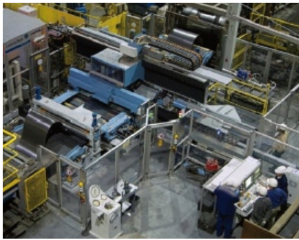
ABBILDUNG 3: Kombiniertes CO 2 -Laserschneid- und -schweißsystem in der Verzinkungslinie der ThyssenKrupp Steel in Bochum.
