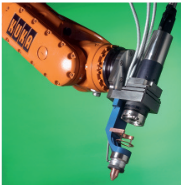
Kombikopf an einem 6-Achsen-Roboter.
