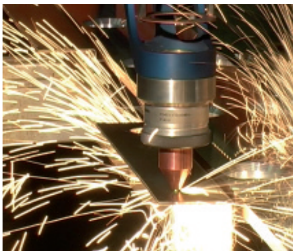
Kombikopf beim Besäumen einer vorher geschweissten, nicht linearen I-Naht am Überlappstoss.
