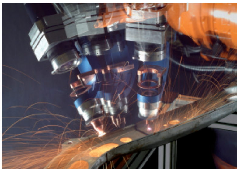
Mit dem Kombikopf kann ohne Werkzeugwechsel geschnitten und geschweisst werden. (Bilder: Fraunhofer ILT)
