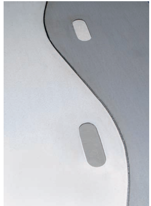
Abb. 3 Beispiel eines nichtlinearen Tailored Blank, das durch integriertes Laserschneiden und Laserschweißen mit dem Kombikopf hergestellt wurde.
